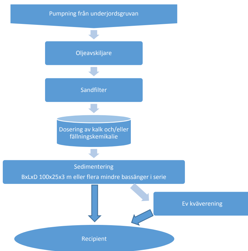
Figur 6: Principschema för rening av länshållningsvatten från gruvan.
