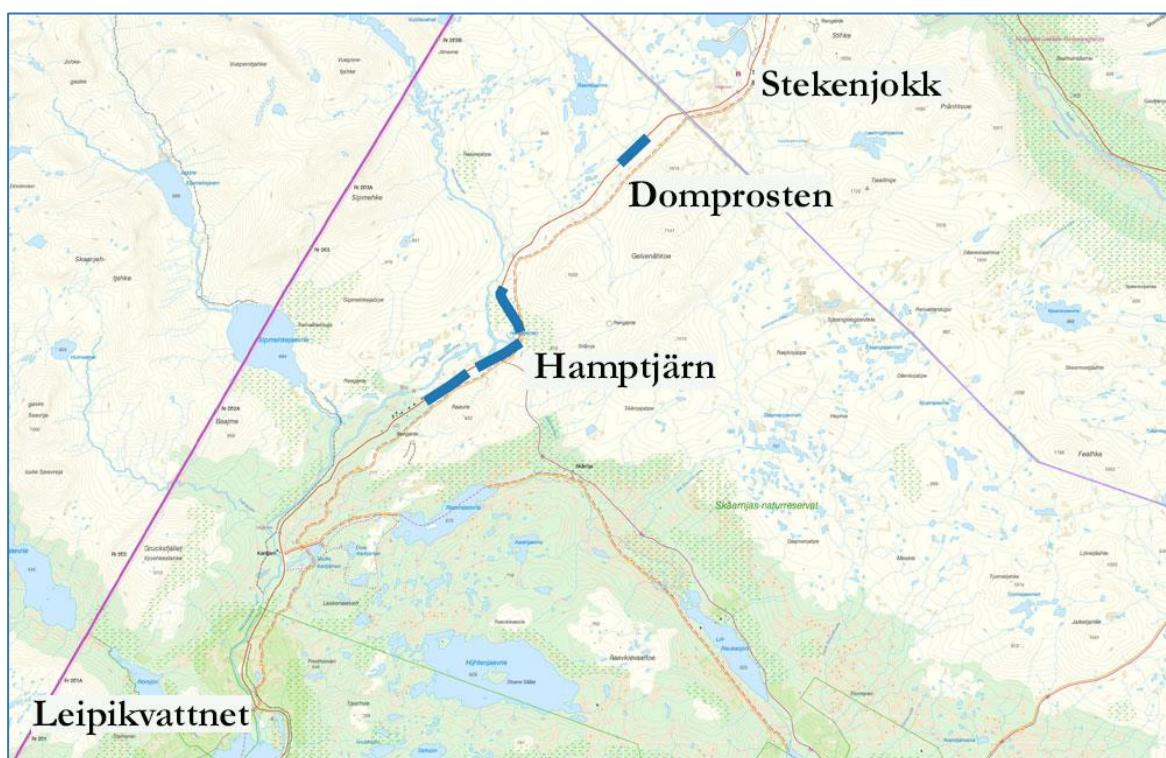
Figur 5. På grund av terrängformationerna där Vildmarksvägen löper mellan Raavre och Hamptjärn respektive kring fjället Domprosten (blå streckad linje) kan snö ackumuleras på vissa platser och vid plogning skapa höga plogvallar.
