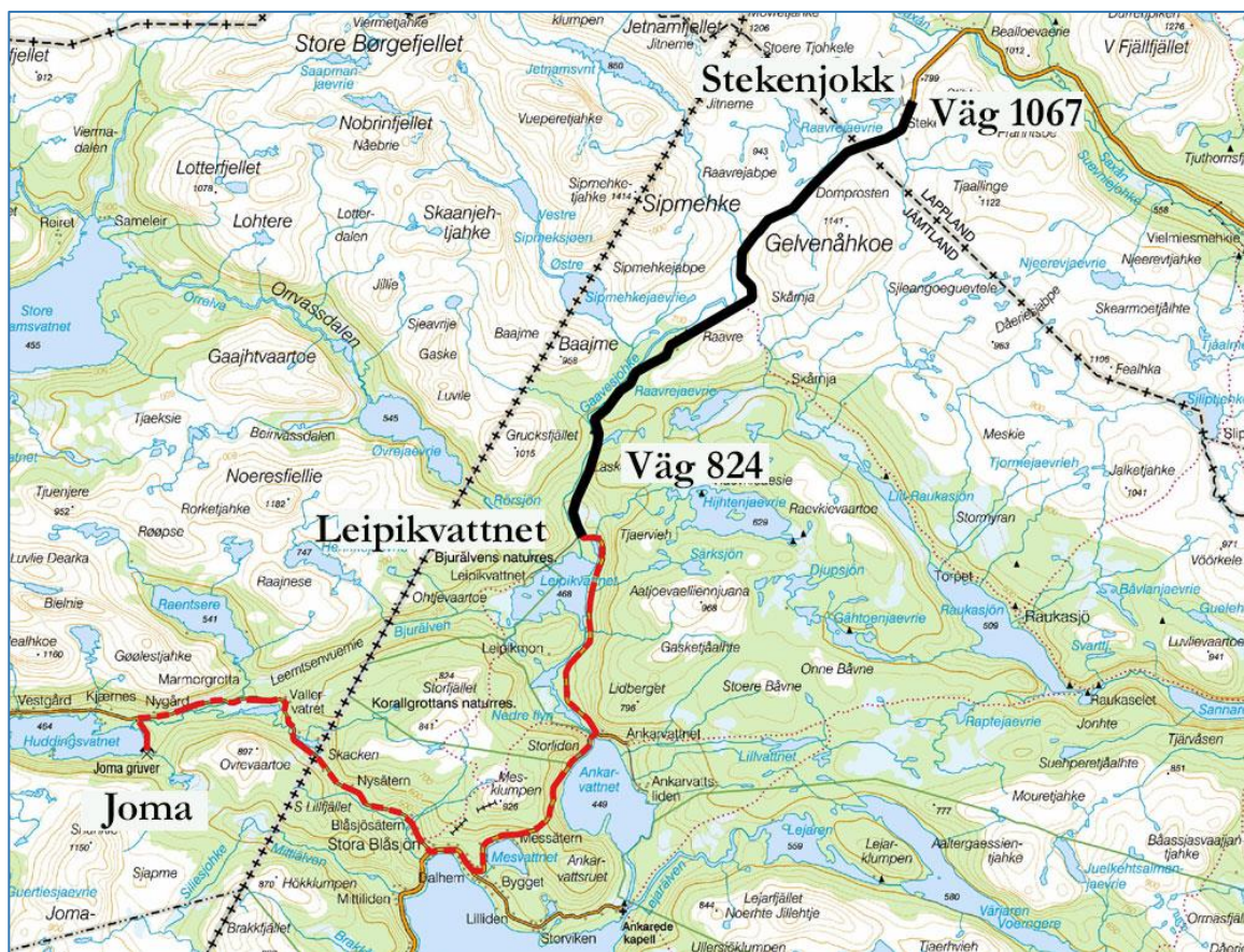
Figur 1. Planerad transportväg av malm från Stekenjokk till Joma i Norge. Röd streckad linje i kartan visar väg som är öppen året runt. Svart linje visar den del av transportvägen som planeras att hållas öppen under vintern, det vill säga mellan Stekenjokk och Leipikvattnet om en sträcka av cirka 23 kilometer.
