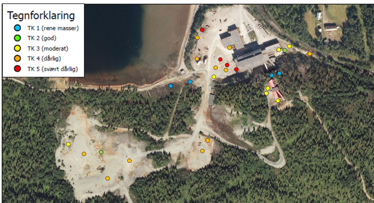
Figur 4-7 Tilstandsklasser av sink i overflatejord. Hvert punkt representerer et gjennomsnitt av fem målinger innenfor en sirkel på 5 – 10 meter (Dato for prøvetaking: 22.09.2020).
