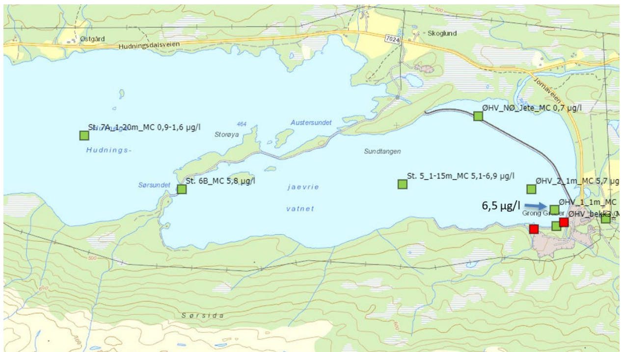
Figur 4-12: Kobberkonsentrasjoner med tilhørende tilstandsklasser i vannprøver hentet i august. Fargekodene er forklart i Tabell 4-3
