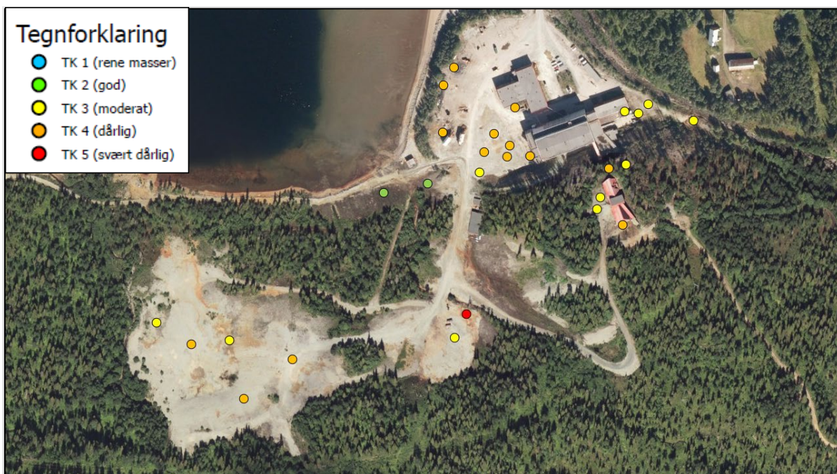
Figur 4-6 Tilstandsklasser av kobber i overflatejord. Hvert punkt representerer et gjennomsnitt av fem målinger innenfor en sirkel på 5 – 10 meter (Dato for prøvetaking: 22.09.2020).
